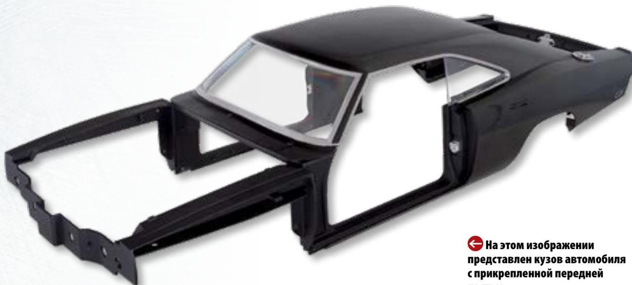
← На этом изображении представлен кузов автомобиля с прикрепленной передней частью.
