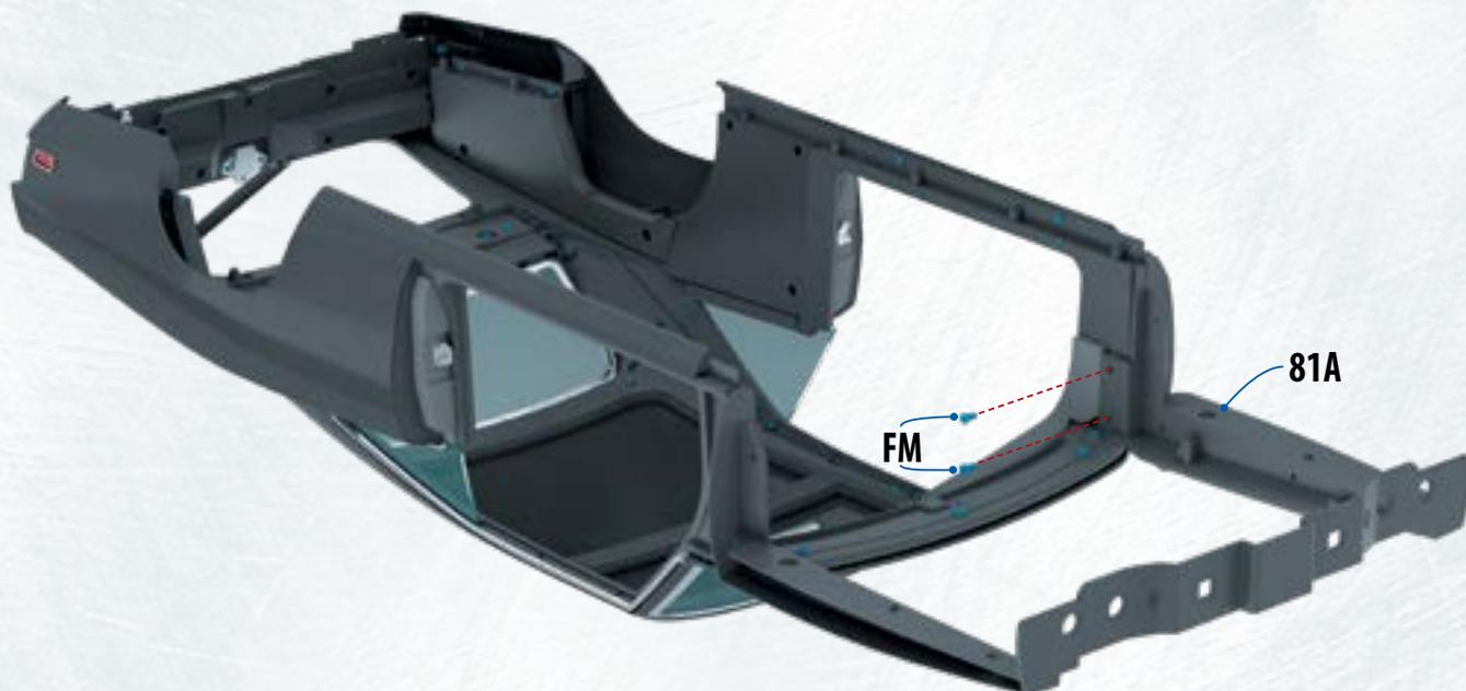
**81.4** **ЗАВЕРШИТЕ** установку передней части кузова, прикрепив ее двумя другими винтами **FM** к правой стороне собранной части кузова. ▲
