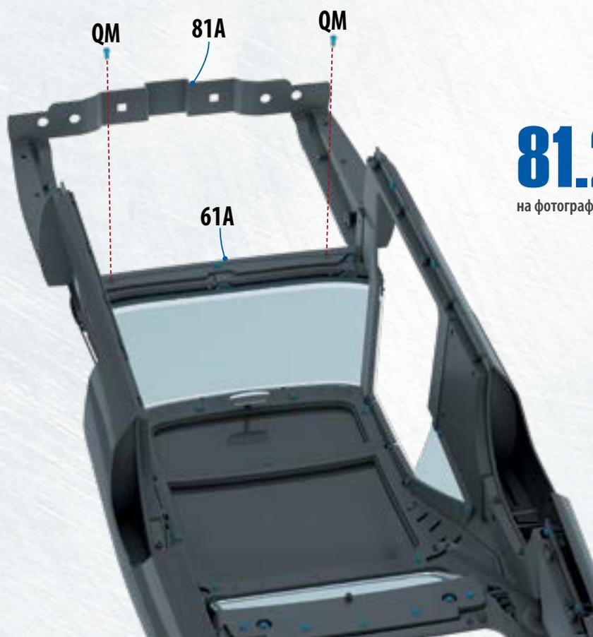
**81.2** **ПРИКРЕПИТЕ** переднюю часть кузова **81A** к детали **61A** еще двумя винтами **QM**, закрутив их в указанные на фотографии отверстия. ◀
